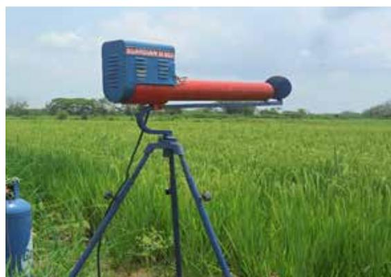
Figura 10. Explosivo con gas para ahuyentar los pájaros.
