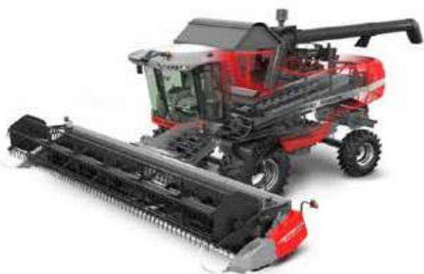
Posee un sistema de ventilación de doble cascada con una variación de 600 a 1300 rpm con un área de limpieza de 4.26mt cuadrados ideales para terrenos de alta inclinación obteniendo menos pérdidas y mayor velocidad de cosecha.
