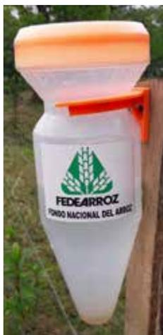
Medición de lluvias en la zona por medio de pluviómetros. Elemento creado durante las MTA e implementado por los productores.
