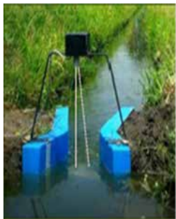
Figura 3. Ubicación del aforador en la entrada del lote tradicional.
