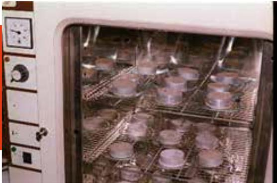
Fig. 6 Método gravimétrico o de la estufa.
