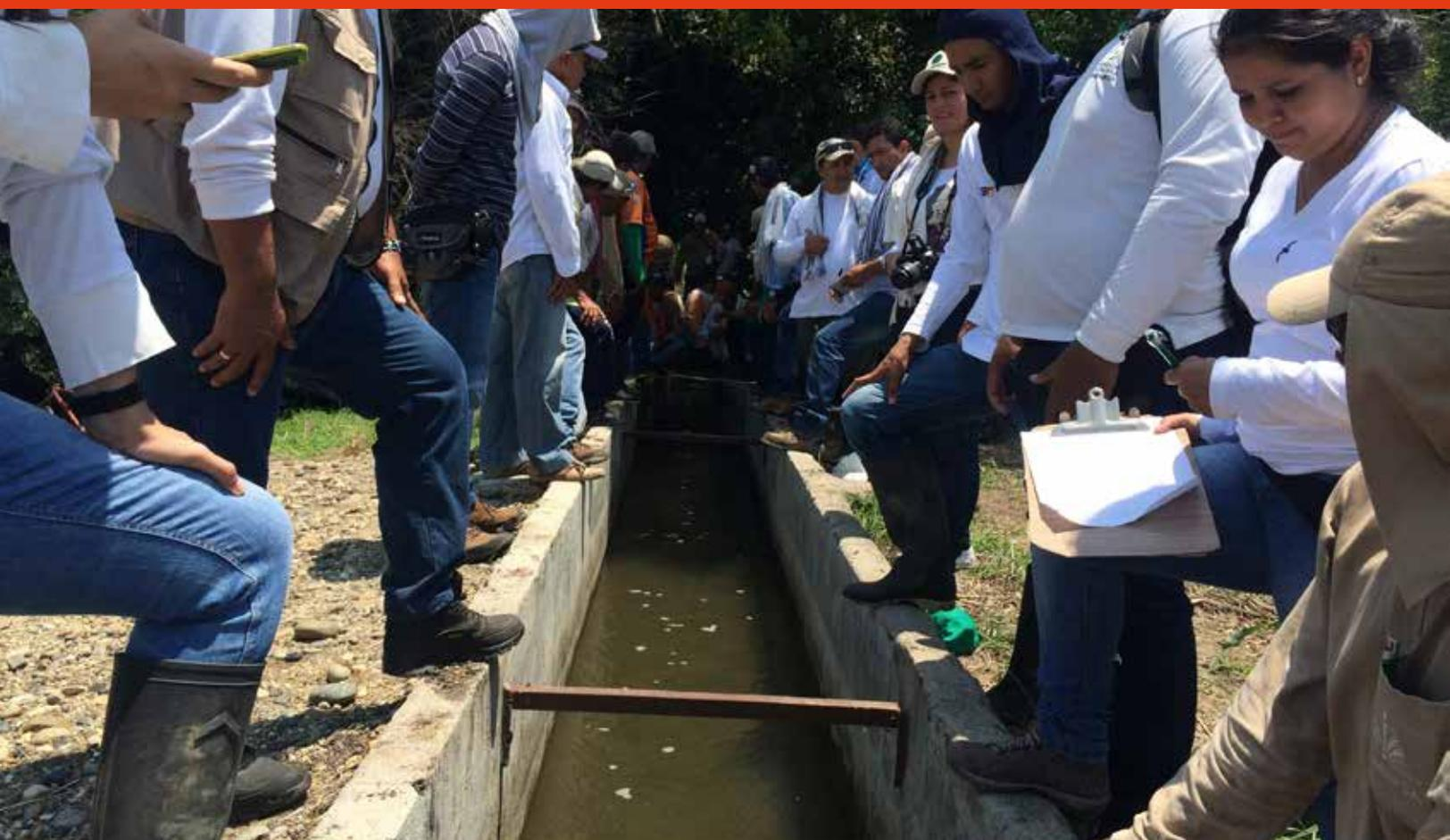
Fig. 5. Método del flotador a través de una sección definida para medir la velocidad del agua.
