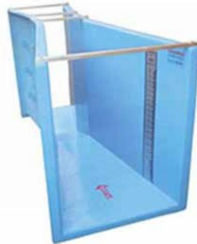
Fig. 3 Canaleta o aforador Parshall con regleta calibrada. /Fuente: Ferrerira , 2011.
