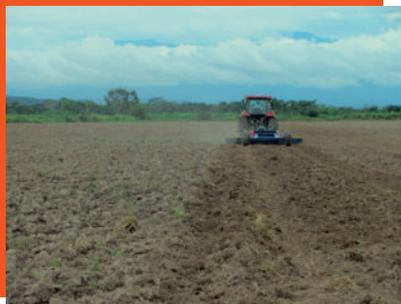
**Figura 3.** Uso de la land plane debidamente calibrada en lotes arroceros.
