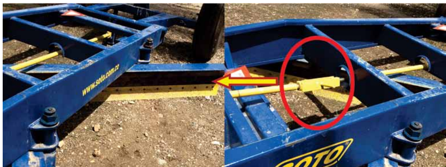
Foto 7. Corbata para la calibración de la pala microniveladora
