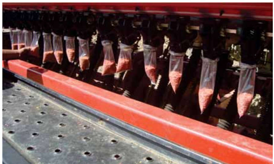
Foto 26. Utilización de las bolsas en la calibración de la sembradora
