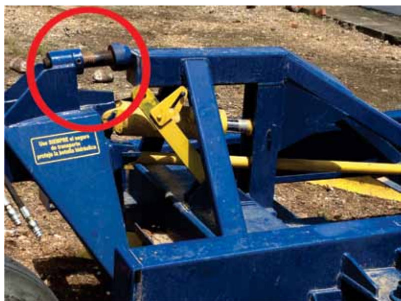
Foto 6. Tornillo para la calibración de los zanjadores
