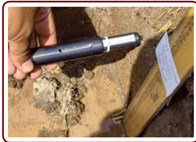
FIGURA 1. Metodología en campo para determinar la resistencia a la penetración
