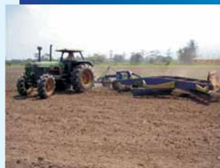
**Microniveladora o pala multicuchillas *Lanplane* ("tierra plana")**
