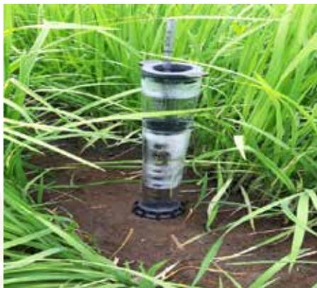
Fig.3. Infiltrómetro – Mini Disk
